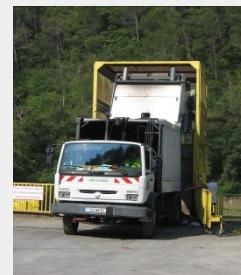
Après la collecte les véhicules vident leur contenu dans un compacteur qui pousse les ordures ménagères dans un caisson étanche de 30 m<sup>3</sup>. Le compacteur se déplace latéralement et peut s'arrimer aux deux caissons positionnés plus bas.
